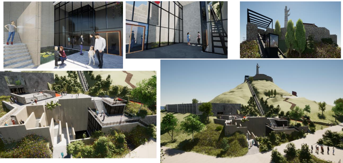
Figura 20. Propuesta del sistema de elevación principal. Elevador inclinado sobre estructura de rampa de hormigón armado y estructura metálica (guía) Altura, 60 metros, desarrollo 128 mts, capacidad 20 per. máx., velocidad 1.5 metros / seg. (nosotros nos encargáramos de la obra civil, rampa, y montaje de la viga o estructura de apoyo al ascensor)
