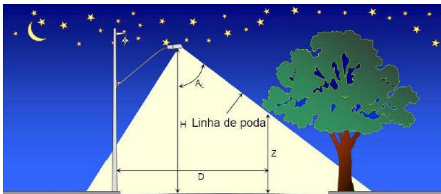
Figura 23.- Proyección de despeje lateral (CEMIG, 2012, p. 8.3)
