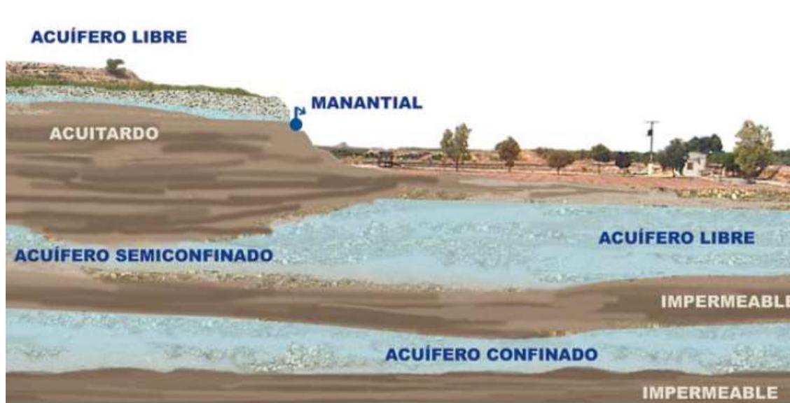
Figura 227. Tipos de acuíferos en función de la presión hidrostática del agua en ellos contenida. Fuente: IGME.
