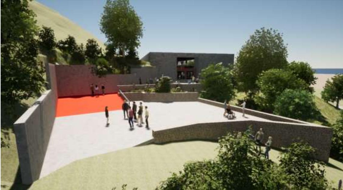
*Figura 252. Las plazas de acceso a las diferentes edificaciones serán ejecutadas en muros de piedra natural o gaviones y sus muros vegetados de acuerdo con estas directrices.*
